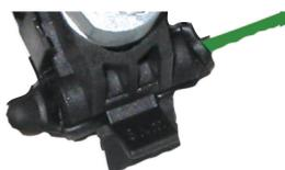
5. Durante a aplicação do torque com a chave sextavada (estrelada) ou cachimbo, assegure-se que os condutores estão alinhados com as canaletas do conector, observando também o posicionamento correto da chave pois caso contrário a cabeça fusível do parafuso poderá romper antes da aplicação do torque necessário.
