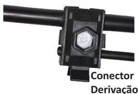
3. Aperte o parafuso inicialmente com a mão até que o conector fixe suficientemente os condutores para posteriormente concluir a instalação com a chave, observe que na região da conexão os condutores devem estar em paralelo.
